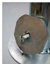
Kraftigt låg med split som låser overrøret fast.
